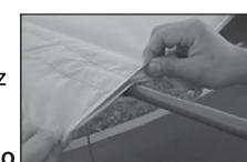
**Étape 3:** Retirez la tige d'auvent de la toile (figure Q). Démontez les tiges d'auvent de la même manière.
